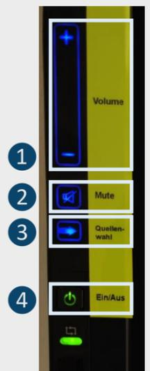
Steuerungselemente an der linken Seite des SMART-Displays
