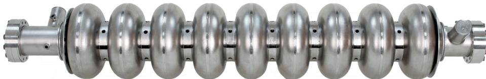
**Abb. 2.1:** Aus Niob gefertigte supraleitende Neun-Zellen-Kavität mit einer Betriebstemperatur von 2 K, einem vorgesehenen Beschleunigungsgradienten von 31,5 MV/m und einer Betriebsfrequenz von 1,3 GHz.
