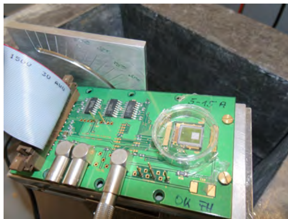
Abb. 3.2: Foto des Detektorchips auf dem SingleChip Board mit Kippscharnier.
