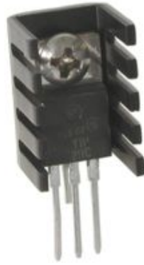
Abb. 3.15.: Ein Spannungsregler mit angeschraubtem Kühlkörper. Dieser reduziert die Arbeitstemperatur des Reglers erheblich.
