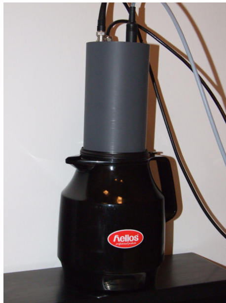
Abb. 1.2.: Eine gewöhnliche Thermoskanne mit aufgeschraubtem Photomultiplier
