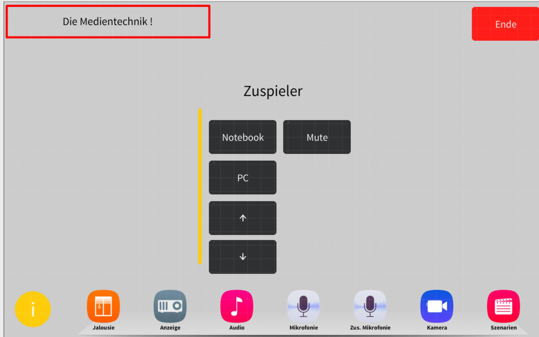
Die Lautstärke der einzelnen Mikrofone kann im Mikrofonie-Menü eingestellt werden. Nutzen Sie hierzu die Pfeiltasten. Um ein Mikrofon ganz aus- oder einzuschalten wählen Sie „An“ oder „Aus“.
