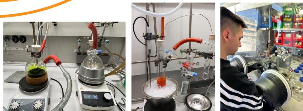
Abb.11-13: Synthese, der fertige Katalysator und das Arbeiten an der Glovebox
